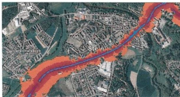
Besonders auffällig ist auch der stark erhöhte Lärmpegel während der Nachtzeiten, wie auf der Lärmkarte ersichtlich. Hier werden erhöhte Lärmpegel mit Werten bis zu 75 dB(A) (lila Markierung) aufgezeigt. (Anlage 2)
